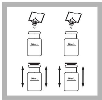
4. 各试管中添加一种水杨酸氨试剂粉包的内容。
