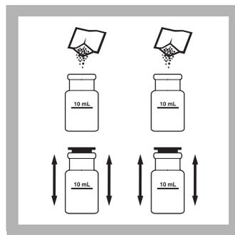
6. 如果定时器到达规定时间，请将一种氰尿酸氨试剂粉包的内容添加到各试管中。
