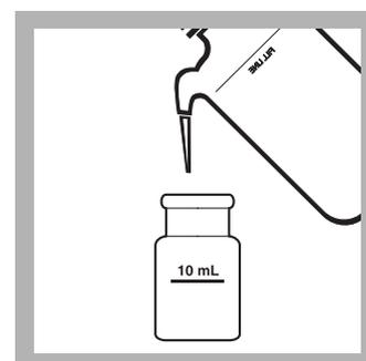
3. 空白值准备：在第二个方形样品试管中灌装去离子水到10 mL的标度。
