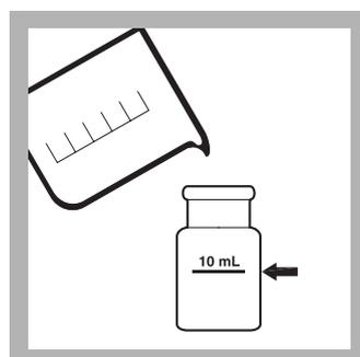
2. 样品准备：在一个方形样品试管中灌装样品到10 mL的标度。
