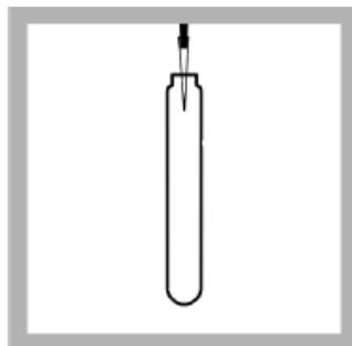
3. 用TenSette<sup>®</sup> 移液枪向一个总磷测试 Test 'N Tube AmVer<sup>™</sup> 试剂管加入5.0 mL 样品。
