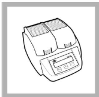
1. 打开DBR 200消解器，加热至150 °C。
