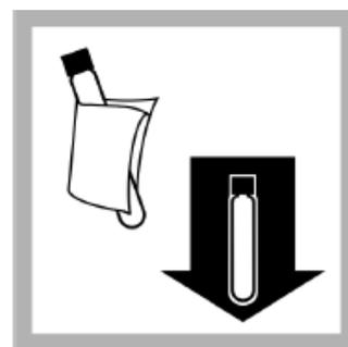
16. 计时时间结束后, 先用潮湿的抹布擦拭试剂管, 再用干燥的布, 擦去上面的指纹和其它污渍。将擦干净的试剂管放入16 mm圆形适配器中。按下“Read(读数)”键读取总磷含量, 结果以mg/L PO<sub>4</sub><sup>3-</sup>为单位。
