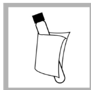
12. 计时时间结束后，先用潮湿的抹布擦拭试剂管，再用干燥的布，擦去上面的指纹和其它污渍。
