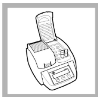
6. 将试剂管插入DRB 200消解器中。盖上防护罩。
